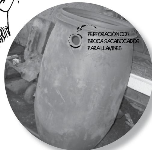
b. Si no se cuenta con la broca que determine la perforación exacta, el agujero se puede hacer con otra broca de menor diámetro y el acabado para la dimensión correcta se logra con la ayuda de una cuchilla filosa.
