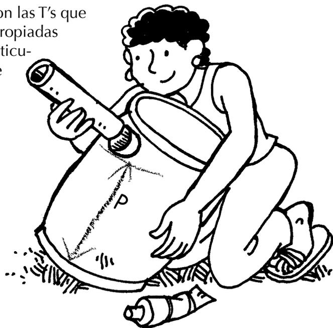
d. Esa unión se pasa a través de las paredes del recipiente, se centra y se fija utilizando el silicón. Debe quedar bien centrada y nivelada. Se deja el tiempo recomendado por el fabricante del silicón, para que exista garantía de la calidad esperada para esa pega. La cual debe ser resistente y debe ser hermética, impidiendo el derrame de agua, o la salida de gases.
