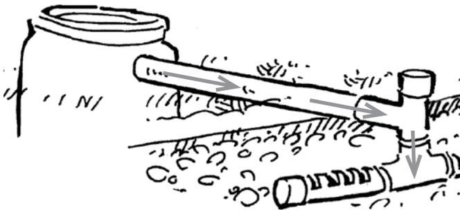
d. Luego de tener los tubos colocados se procede a "echar" material a los lados de los recipientes y a compactar ese suelo. Cuando se hace este trabajo es conveniente ir también colocando agua dentro de los recipientes, para que no se "aplasten" con la presión del suelo cuando se esta compactando. Esto incluso ayuda, debido a su mayor peso, a determinar en forma más segura la posición correcta de los tanques y requerida por los niveles.
