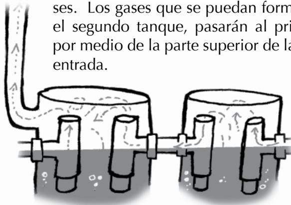
**c.** En el recipiente donde se coloca esa línea de ventilación, se ubica la salida de ella en la parte más alta del recipiente, porque los gases tienden a acumularse en las partes altas. Esa salida y esa línea de ventilación se recomienda colocarla en un diámetro no menor a 25 mm.
