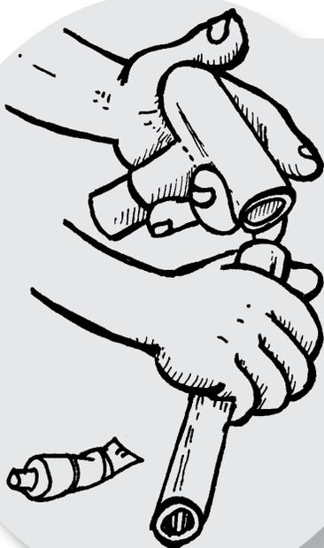
g. A cada una de las T's se le pegan los "niples" (pedazos adicionales de tubo), utilizando el pegamento solvente apropiado. **Se pega el pedazo que va hacia abajo, como el pedazo que entrará en la figura que se coloque en la pared del recipiente.** Antes de manipular o colocar en la posición final a esas piezas se ha dejado el tiempo recomendado para asegurar que la pega sea buena.
