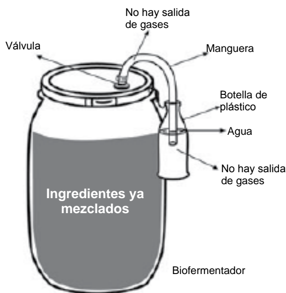
Recipiente con el biopreparado listo para usar después de 30 a 90 días de haber fermentado (observar salida de gases paralizada)
